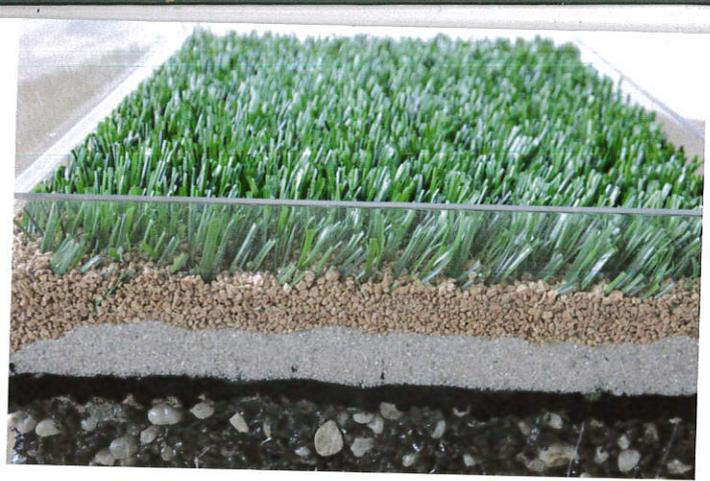
Querschnitt durch den Aufbau einer Kunstrasenfläche: Das Einstreugranulat links besteht aus Mikroplastik, rechts besteht die oberste Schicht des Füllmaterials aus Kork.
