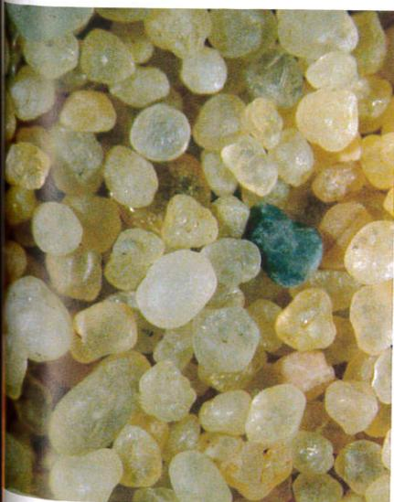
Eine Alternative zu Mikroplastik als Einstreugranulat ist die Verwendung von Einkornquarzsand.
